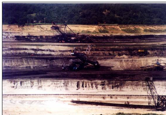
Fig. 1. Modul de stratificare și de exploatare a lignitului
