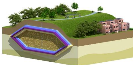
Fig. 2. Schema de prezentare a impermeabilizării și reconstrucției ecologice a unui depozit de deșeuri
